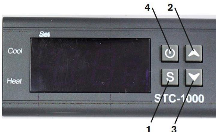
Терморегулятор служит для нагрева воды в водяной рубашке до определенной температуры. Он работает, опираясь на два параметра, которые можно настроить в меню терморегулятора: температура (F1) и падение температуры (F2).
