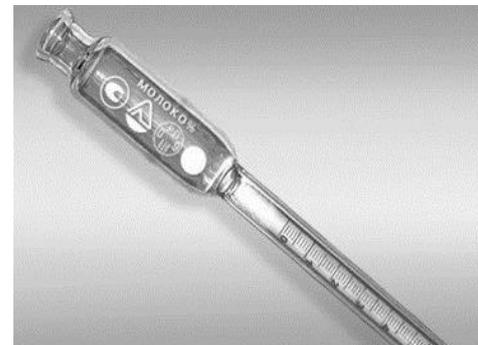
Принцип действия основан на разложении белковых веществ кислотами и изоамиловым спиртом с последующим разделением веществ путем центрифугирования.
