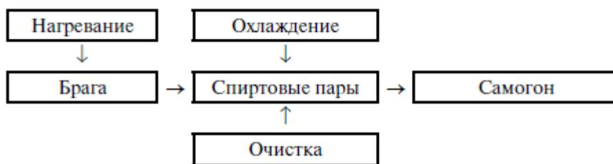
Рис. 1. Схема процесса перегонки
