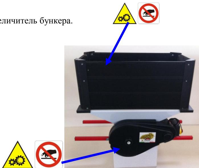
**Рис. 2. Опасные движущиеся механизмы**
