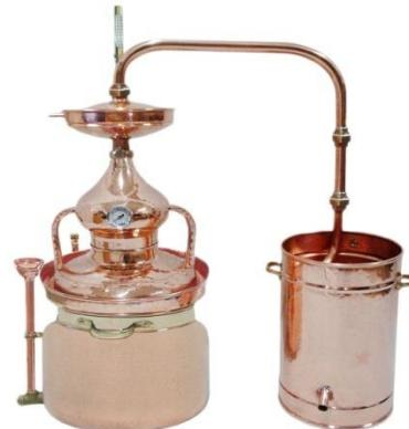
Аламбик на водяной бане – дистиллятор, отличительными чертами которого является то, что все узлы котла выполнены методом высокотемпературной пайки. Для удобства охладитель оснащен тремя штуцерами: для подвода и отвода воды, выхода готового продукта. Купол и холодильник соединяются пароотводной трубкой с резьбовым соединением. Водяная баня препятствует пригоранию частиц нефильтрованной браги к стенкам куба. Производительность аппарата составляет около 4 л/ч.
